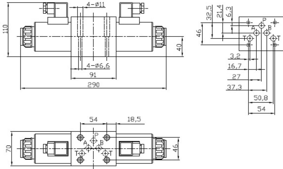
**Схемы для распределения потока жидкости для гидрораспределителя BE10 с двумя электромагнитами**
