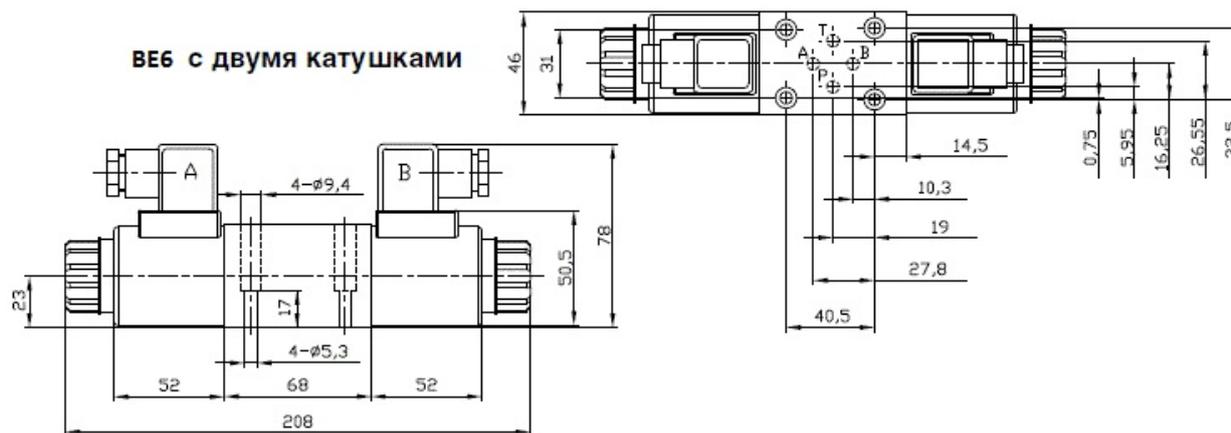
**Схемы для распределения потока жидкости для гидрораспределителя ВЕ6 с двумя электромагнитами:**
