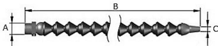
Пример: Трубка для СОЖ 02-400/3 (G1/4,L400мм,d3мм)
