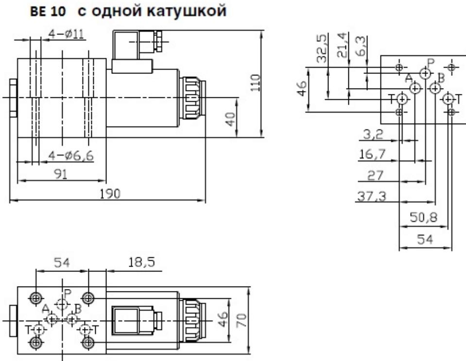
**Схемы для распределения потока жидкости для гидрораспределителя BE10 с одним электромагнитом:**
