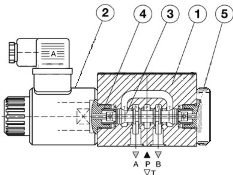
Гидрораспределители состоят из корпуса (1), золотника управления (3) одного или двух электромагнитов (2) с возвратными пружинами (4). У четырёхлинейного двупозиционного (4/2) ВЕ6.574А, ВЕ6.574, ВЕ6.574Е, ВЕ6.573, ВЕ6.573Е гидрораспределителя нет центральной позиции золотника. Для перемещения золотника
